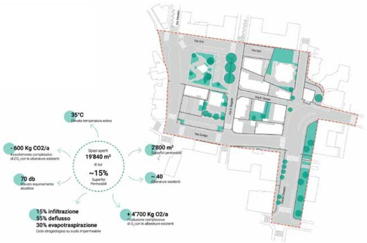
**Analisi dell'elevata percentuale del suolo impermeabilizzato (situazione esistente)**
