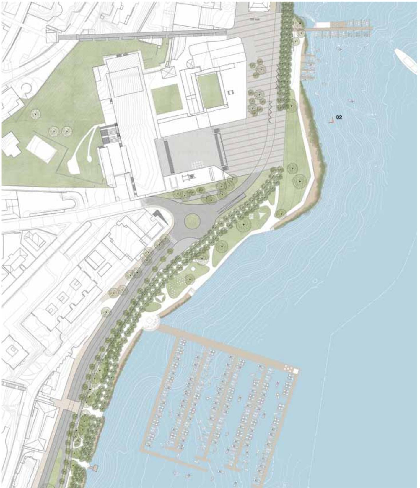
**Planimetria del settore 1; il porto Belvedere, rivisto e ampliato, permette di concentrare qui parte delle imbarcazioni che oggi occupano la riva**
