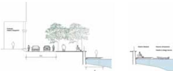
Sezione in corrispondenza di Riva Caccia e dettaglio della nuova passerella a filo d'acqua
