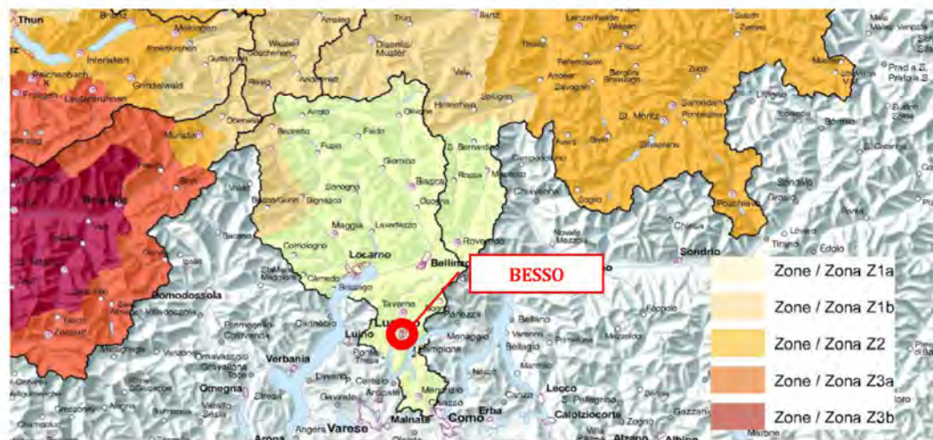
Fig. 20: estratto mappa delle zone sismiche, norma SIA 261 (ed.2020), allegato F
