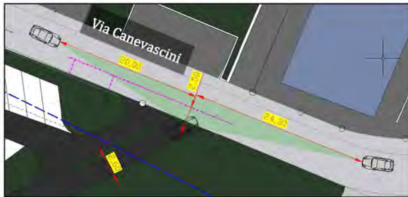
Figura 5: accesso del parcheggio Ovest su Via Canevascini
